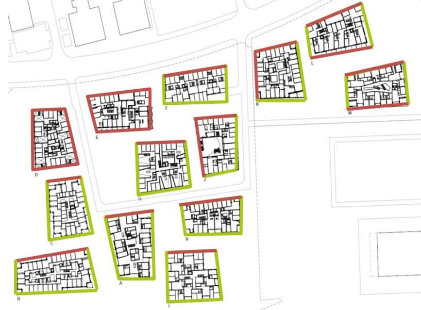
Abb. 10: Übersicht der mit PV-Modulen belegten Fassaden (in grün) des Hunziker Areals
