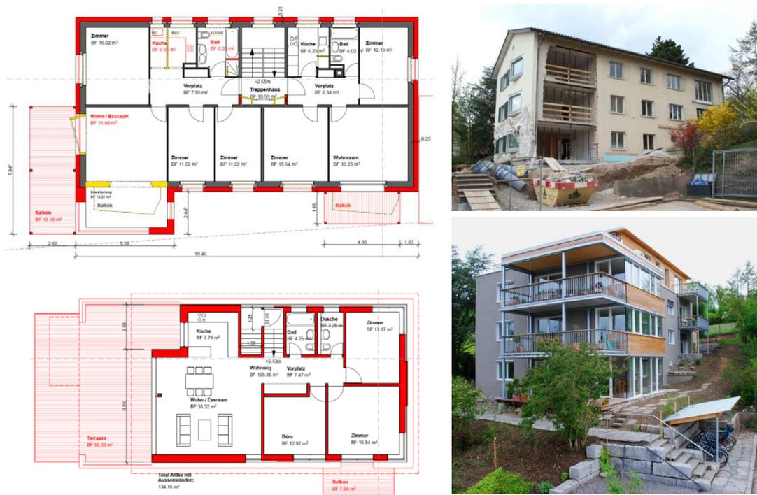
Figur 7: Segantinistrasse - Grundriss 1. OG (oben) und DG (unten), Ansicht von Süden während und nach dem Umbau
